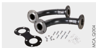
2 curve a 90° DN 65 per impianti in cascata da 304 a 455 kW - Collo HC209 2 curve a 90° DN 100 per impianti in cascata da 460 a 608 kW - Collo HC210 Forniti con guarnizioni, bulloni e dadi. Consentono il collegamento del compensatore idraulico perpendicolarmente al collettore.
