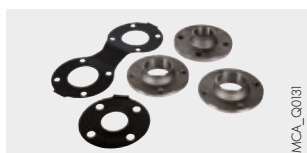
Serie di controflange da saldare DN 65 per impianti in cascata da 304 a 455 kW - Collo EH669 Serie di controflange da saldare DN 100 per impianti in cascata da 460 a 608 kW - Collo HC218 Contiene 3 controflange: 2 per il lato di installazione del compensatore idraulico (DN 65 o DN 100) e 1 per il tubo del gas (DN 50 o DN 65). Fornite con guarnizioni, bulloni e dadi.
